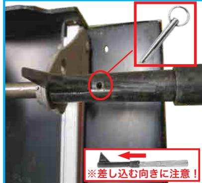
固定タイヤ金具をタイヤを外した支柱に差し込む。
